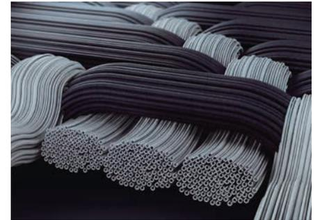
紡績の段階で繊維の内側を空洞にし、従来のデニムの軽量化を実現させた特殊中空糸の断面(拡大図)。この糸の発明が、ジーンズを軽くすることに成功した。
