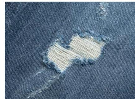
デニム生地は染色された縦糸と染色されない横糸で織られている。縦糸が切れて白い横糸が見えるダメージ加工。裏から「あて布」がされている。
